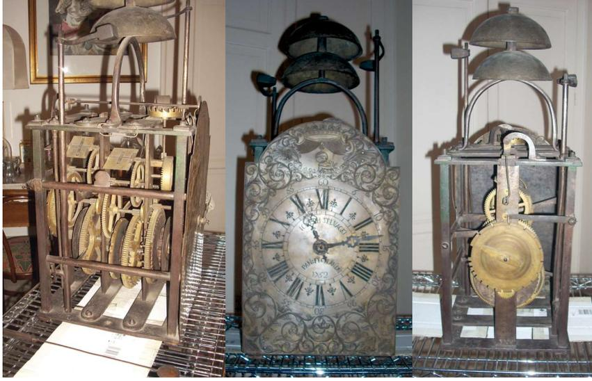
Particolare del movimento, con i tre treni dei rotismi in sequenza
