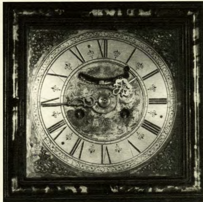
Pendola palermitana con cassa lastronata in tartaruga; quadrante segnato "Nicolaus Magri fecit - Panormi"; movimento a pendolo con scappamento a verga; gran suoneria delle ore e dei quarti su campane
